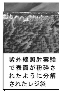
紫外線照射実験で表面が粉碎されたように分解されたレジ袋
