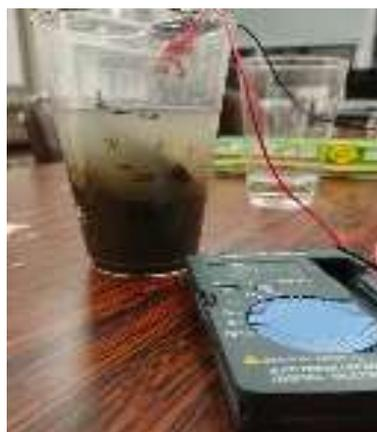
図5 微生物燃料電池実験
