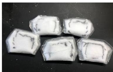
希釈した腐葉土及び土壌を晒の中に入れ、ポリエチレン-ポリプロピレン材質のものでシールしたもの
