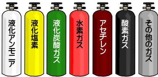
＜高圧ガス容器の塗色＞ (高圧ガス保安規則第10条)
