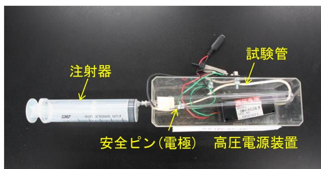
図1. 作成した簡易放電装置
