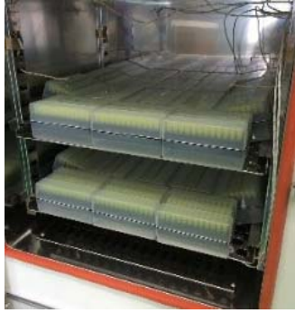
写真：過剰な乾燥物の詰め込み例
