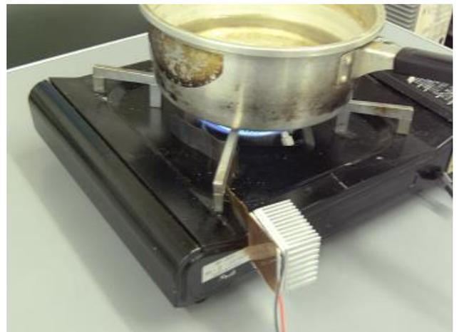
図5 ヒートパイプの代わりに銅板を使用
