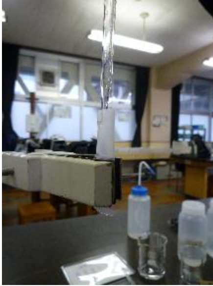
写真16 パックテストに試料水2mLを加える様子
